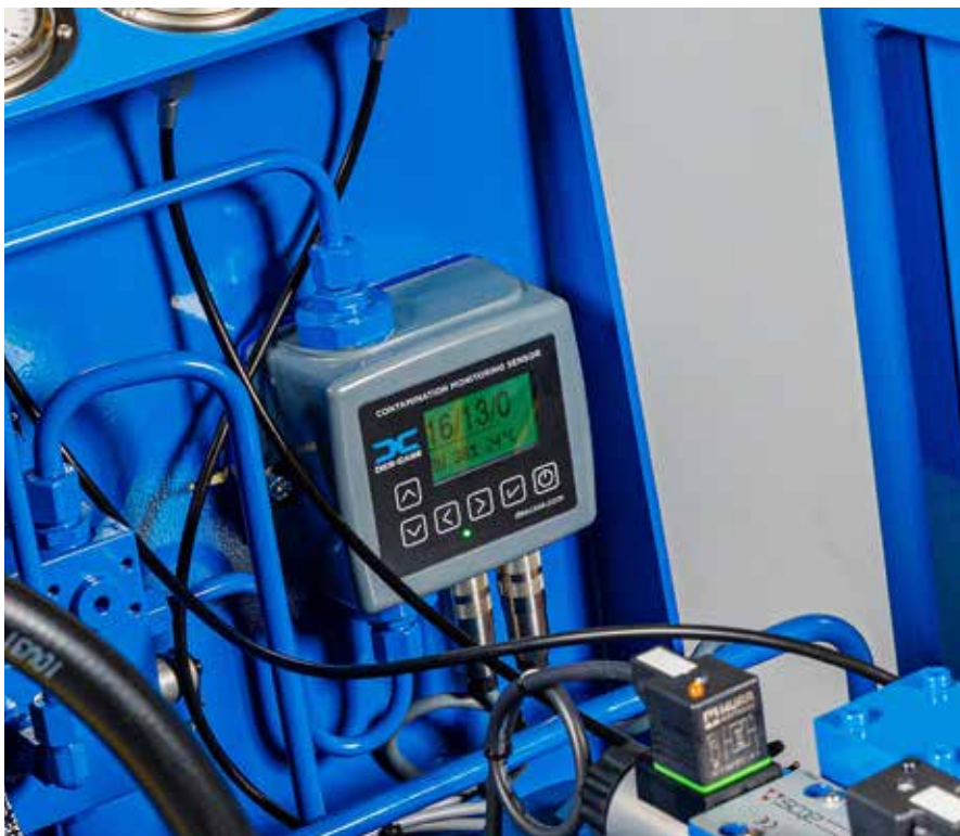
De permanent gemonteerde inline deeltjesteller meet en toont automatisch deeltjesverontreiniging, vocht en temperatuurniveaus.
